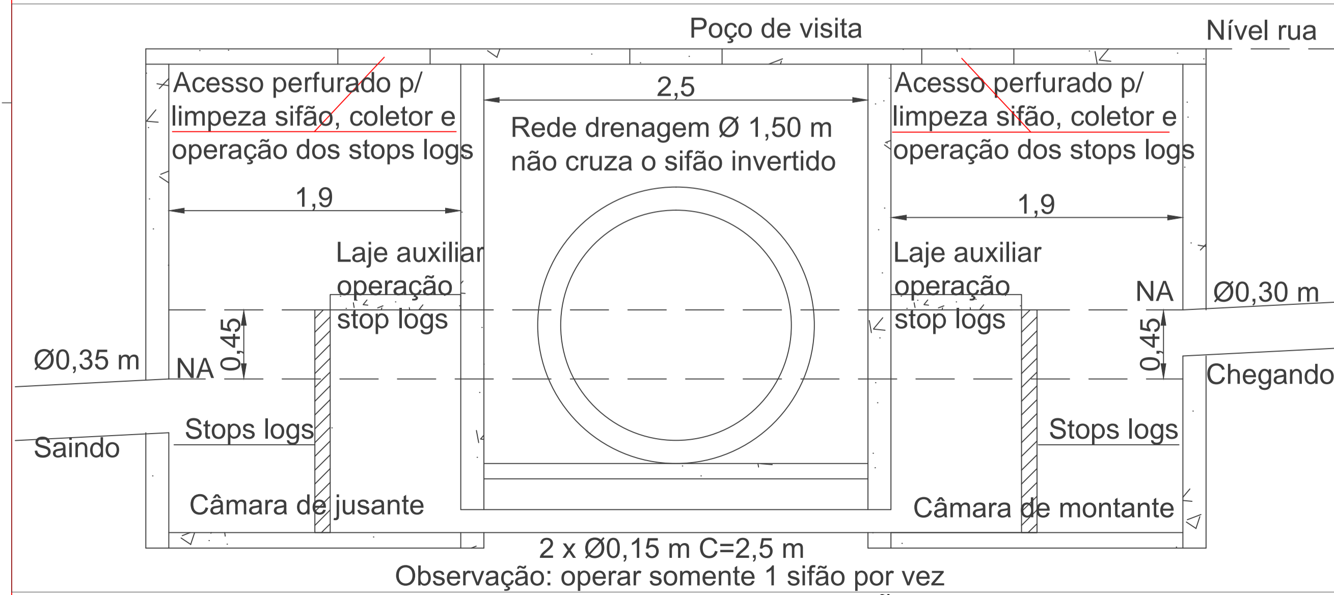
PERFIL SIFÃO INVERTIDO ESCALA : 1:25
